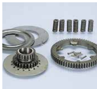
202.0000 Vespa 125 PX,TS Sprint Z=23/64 Primary ratio-Primario
